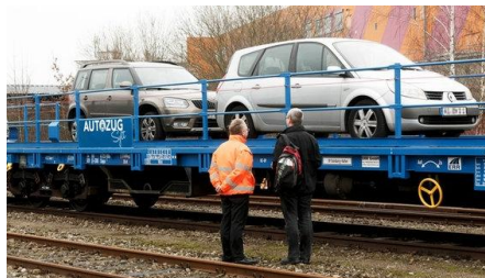
RDC hat gebrauchte Güterwagen umbauen lassen. Neu ist ein Notbremsseil. Das ist notwendig, weil die Fahrgäste im Auto sitzen bleiben.
